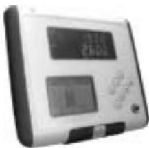
省エネナビとはご家庭の分電盤に取り付け、電気料金、電気使用量、二酸化炭素排出量などをリアルタイムで表示する機械です。
