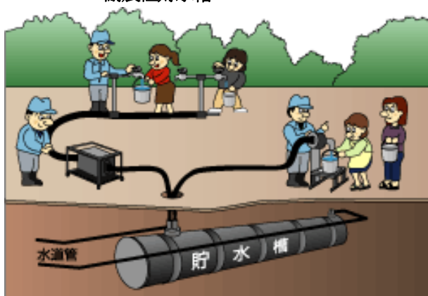
耐震性貯水槽
