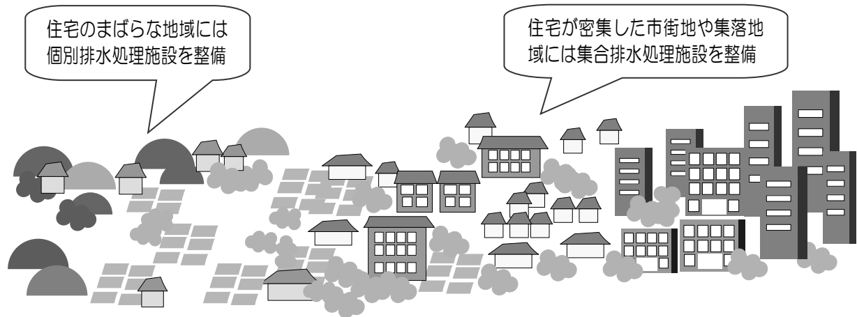
図4-1-2. 集合排水処理施設・個別排水処理施設の考え方
