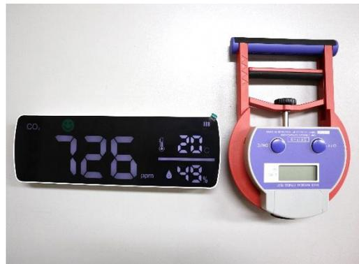
CO2 モニターは、二酸化炭素濃度を 400～5000ppm まで測定可能で、400～999ppm の範囲内ならば緑のアイコンが表示され、適切であることが分かります。温度と湿度も同時に表示しており、各自治会の行事に貸出すこともできます。
