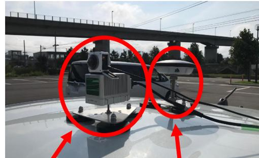
LiDAR（左）、GNSSアンテナ（右）
