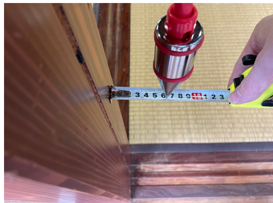
近景:120cm で 12mm 傾斜している(上 5cm)
