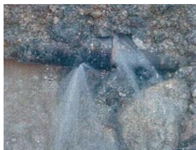
非耐震管（VP、TA）継手部からの漏水
